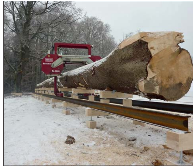
Serra-Bandsäge mit einer Grundrahmen-Sonderanfertigung vom Zimmerer. Der rund 4 t schwere Starkholz-Koloss war für die marktüblichen Mobilsägen schlichtweg zu lang.
